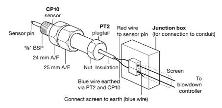
Fig. 3 Wiring diagram
